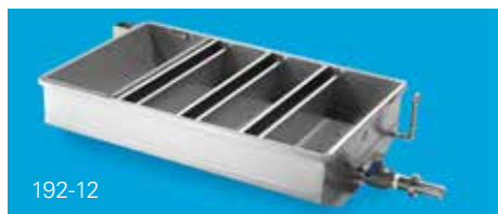
192-12 CFM Honungssump tillverkad i rostfritt, klarar ca 250 kg. 3000 W / 230 V. Med kulventil och slanganslutning. 1300x820x320 mm. Pris på begäran
